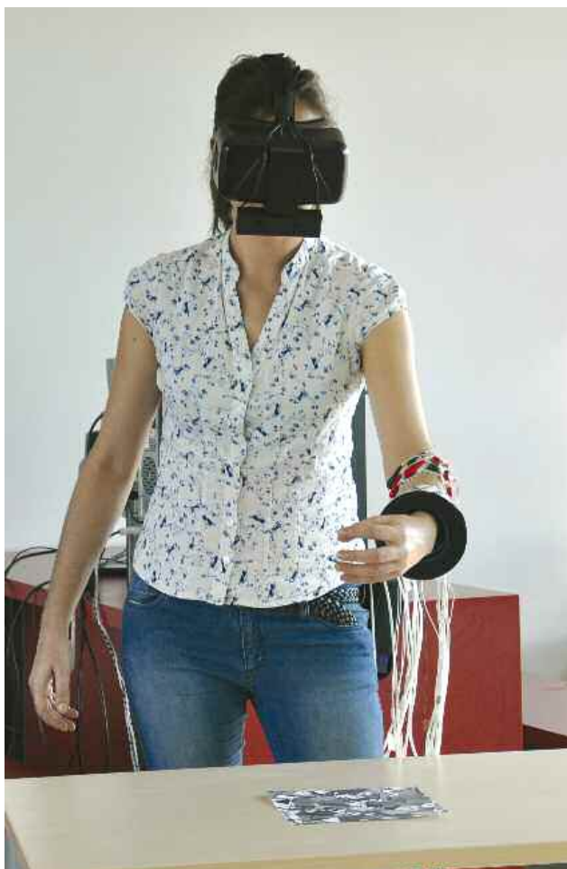
Masterstudentin Olga Mikhaylova testet die virtuelle Armprothese. Durch die Brille sieht sie anstelle der Handgelenksmanschette den virtuellen Arm.
